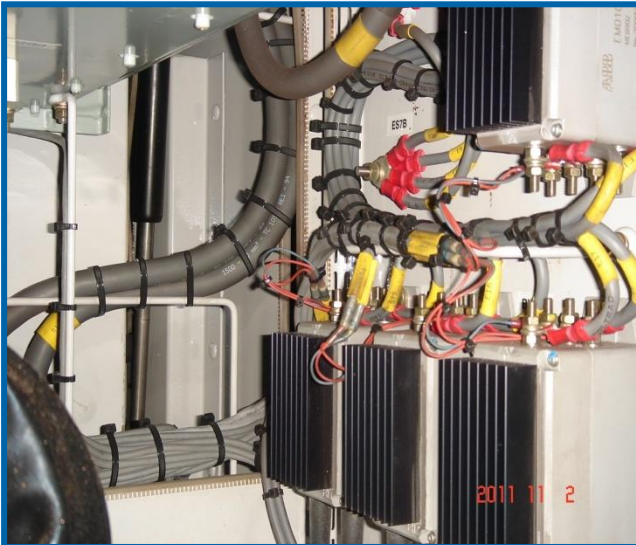
차량 인버터 배면 내부 (콘넥터부 상세)
